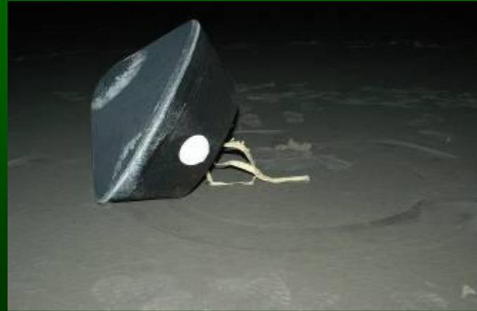
A destra il modulo recuperato a terra il 15-1-2006 con i campioni incastrati nell'aerogel: 10 frammenti di dimensioni di 100 micrometri ( $1\mu\text{m}=1$  milionesimo di metro)
