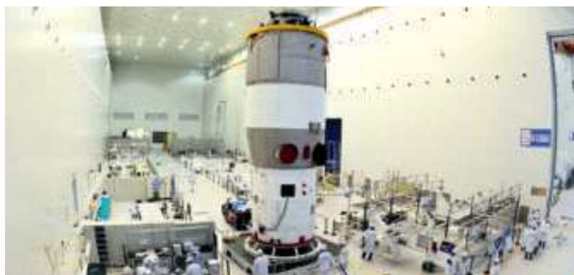
▼ La Tiangong in fase di preparazione. La stazione è stata lanciata il 29 settembre 2011. Le sue dimensioni sono di 10,4x17x3,3 metri.
