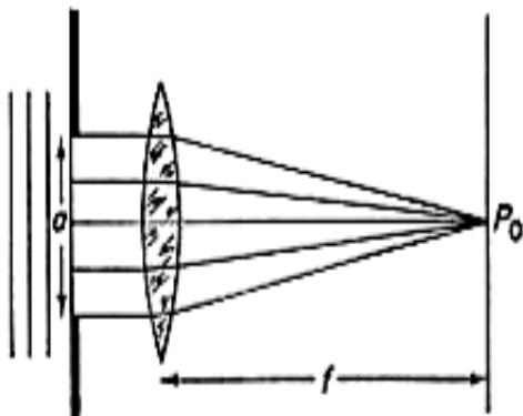
Figura 2. Massimo centrale nella diffrazione di Fraunhofer.
