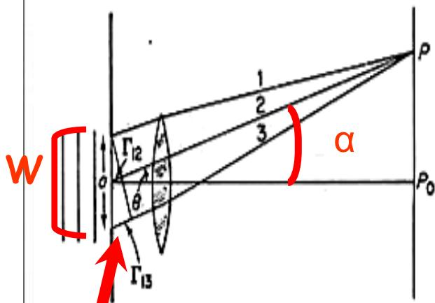
Figura 3. Diffrazione di Fraunhofer.
