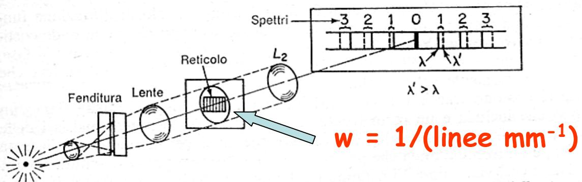
Figura 2. La formazione di una riga spettrale in un reticolo a diffrazione. Viene mostrato lo spettro di una sorgente che emette su due lunghezze d'onda  $\lambda$  e  $\lambda'$ .
