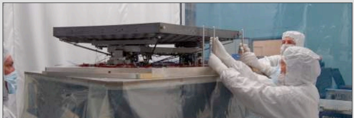
Sine burst test setup (z-axis)
