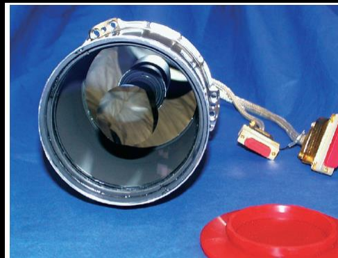
Ottiche SRC (Matsukov Cassegrain lunghezza focale 975 mm, ottiche 210 mm)
